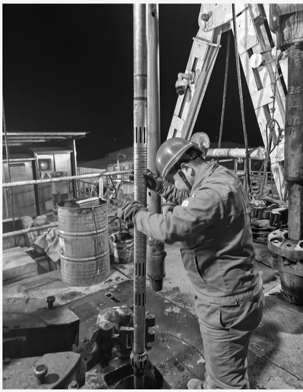
近日，安徽省煤田地质局一队在刘庄煤矿XL3三维地震反反射波异常区探查工程4-2前探孔项目中，依托“水平井标准测井+井中瞬变电磁测井”双重技术，开展精细化地质探测，成功查明XL3陷落柱长轴延伸方向、长度及空间赋存特征，彻底摸清隐蔽地质体“家底”，破解了此前地质构造模糊不清的技术难题，为XL3陷落柱后期治理、优化施工方案提供了可靠的地质依据。 张毅 摄影报道
