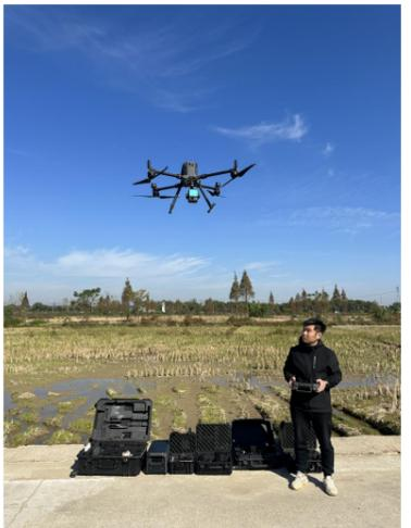
操作大型无人机进行高标准农田地形勘测
