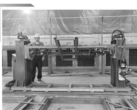
4月17日,陕西盾实人防设备工程有限公司自主研发的4台人防门框加工平台进入调试运行阶段。该设备配套使用购置的自动校直机、六枪焊机,将大幅提升1520型以内门框加工生产效率,减轻作业人员劳动强度,预计每年可节省成本50万元以上。袁刚 摄影报道
