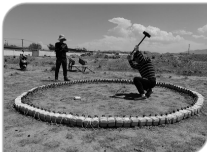
物测遥感所物探技术人员在花草滩煤矿高密度三维地震勘探项目中进行智能节点式地震仪一致性测试
