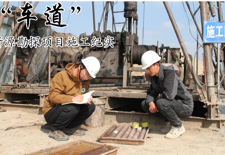
地质技术人员与钻机机组沟通取芯情况
