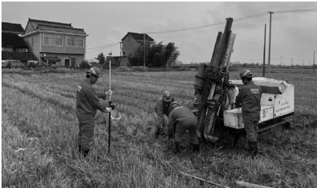
浙江煤炭地质勘查院(中煤浙江检测技术有限公司)于6月4日提前完成了重点民生工程“安吉县杭城镇桐坑村社会福利中心二期扩建项目”地块土壤污染状况初步调查。技术人员对地块进行了现场土壤、地下水采样。经过样品测定,该地块满足一类用地要求,不属于污染地块,无需启动详细调查及风险评估程序,可进入下一步规划用地的开发利用。 胡颖 摄影报道
